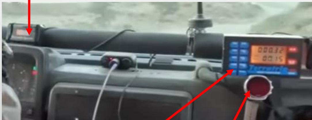
Terratrip / odomètre étalonné, donnant la vitesse compteur et mètres parcouru
